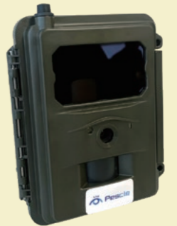
ネズミを検出するカメラ(赤外光LED付き)とモーションセンサー、通信装置が一体化された「Pescle Rodents」。単3電池(12本)仕様のため、任意の場所に設置すれば直ちに運用できる。検出可能距離は約5m
