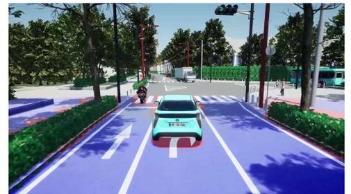
「RoAD to the L4」のテーマ2・テーマ4の取組みにおいて、この活動に参画するJARI（日本自動車研究所）より2021年度から委託を受け、無人自動運転移動サービスの実現に向けて、ODD設定に応じた自動運転システムの安全性評価を行うため、ひたちBRTの一部・柏の葉エリアの一部をWARXSSの仮想環境上に構築しました。
